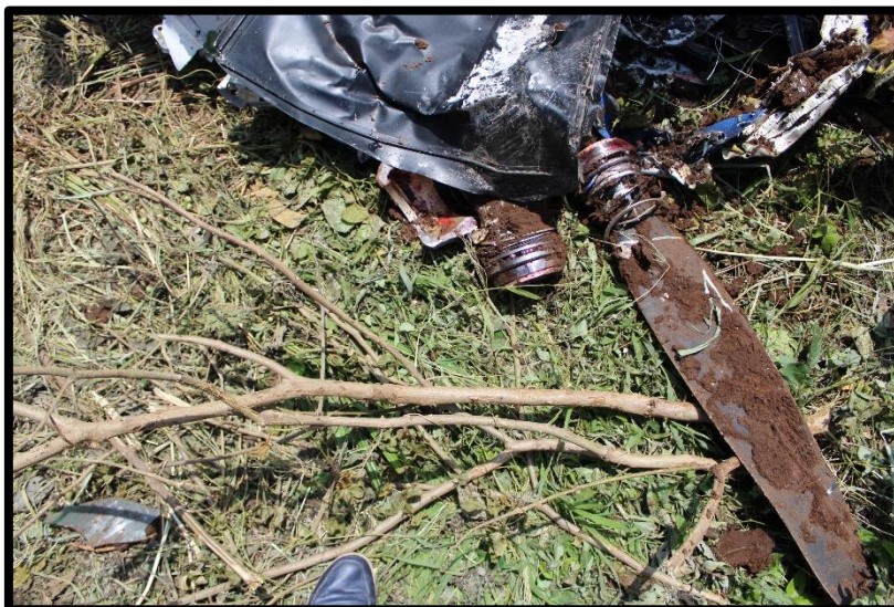
Fotografía No.: 17 Hélice fragmentada por el impacto.
