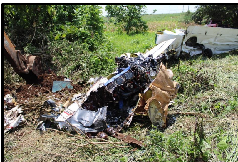
Fotografía No. 14 El motor extraído del lugar donde se enterró al momento del impacto.
