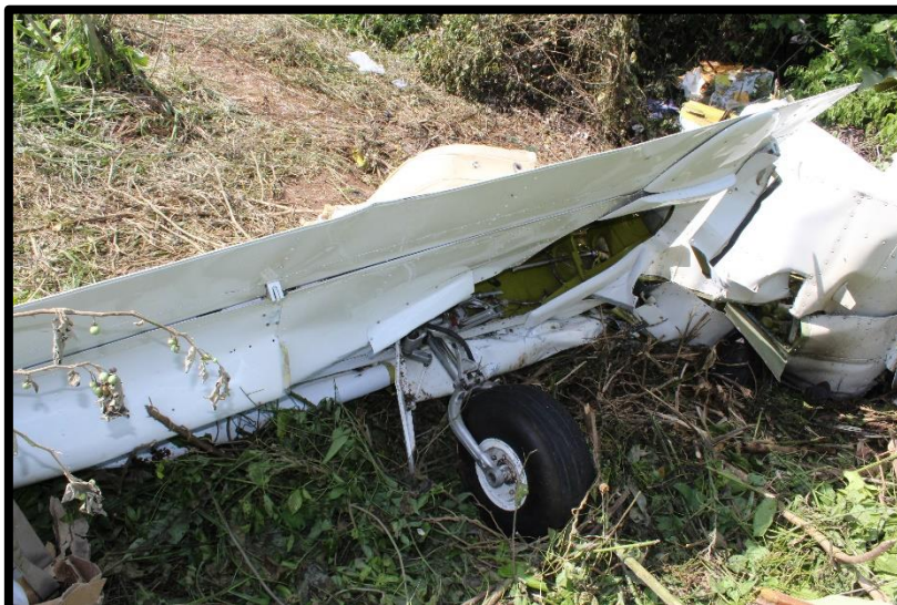
Fotografía No.: 7 Parte baja del ala, nótese el tren de aterrizaje extendido.
